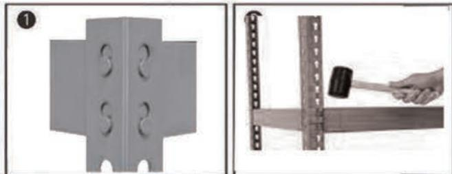
2. Assemblare i telai di estremità con le travi corte laterali e unire con le travi lunghe anteriore e posteriore.
