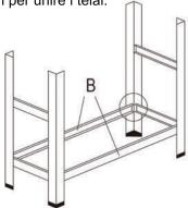
**3.** Inserire il connettore del montante nella parte superiore del montante inferiore. Spingere il montante superiore in posizione o battere con il martello se necessario
