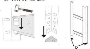
2. Assemblare i telai di estremità con le travi corte laterali, et e aggiungi lunghe travi anteriori e posteriori per unire i telai.
